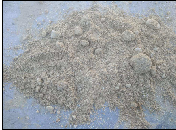
Sol : Argile sableuse beige à graviers et niveau de sable (altération des marnes) Tarière T1: prélèvement de sable de - 2,50 m à - 2,80 m.
