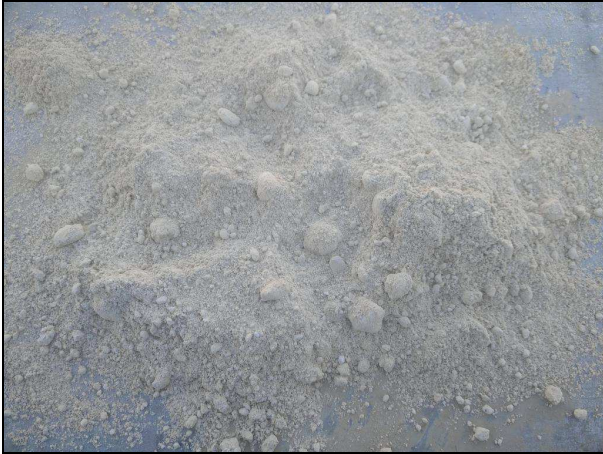
Sol : Argile sableuse beige à graviers et niveau de sable (altération des marnes) Tarière T1: prélèvement d'argile sableuse beige de - 0,3 m à - 2,5 m/TN.
