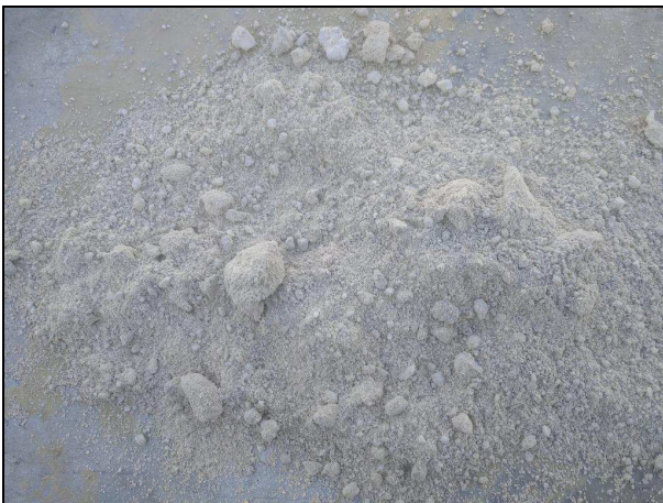
Sol : Marne blanchâtre à blocs de dolomie Tarière T6: prélèvement de - 0,3 m à - 2,3 m/TN.
